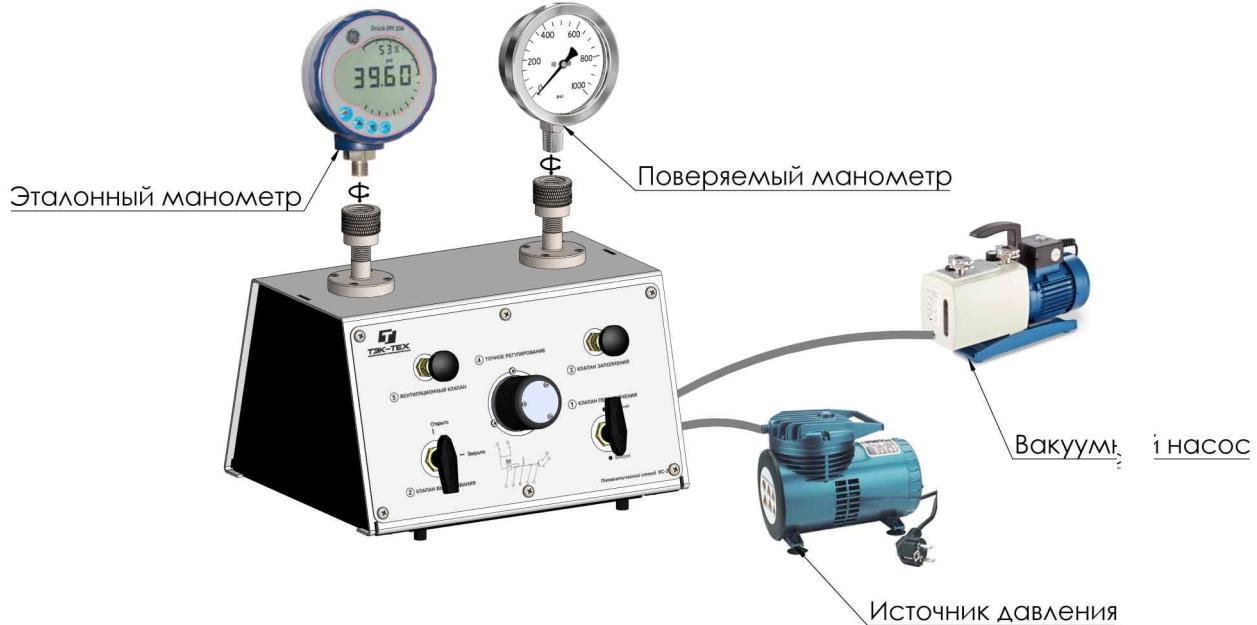
Рис. 5.1 Схема внешних соединений стенда KC-2
