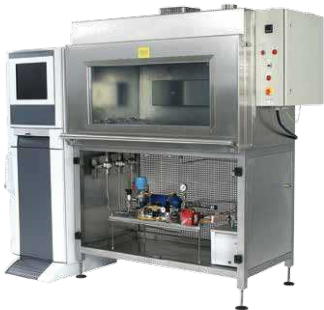
Стенд для проведения испытаний на разрыв - гидростатические испытания шлангов радиатора автомобиля
